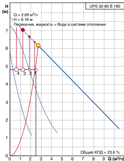
Рис. 4.38. Расчетная характеристика смесительного насоса UPS 32-80 В 180 (поз.Р3.1 рис.4.28)
