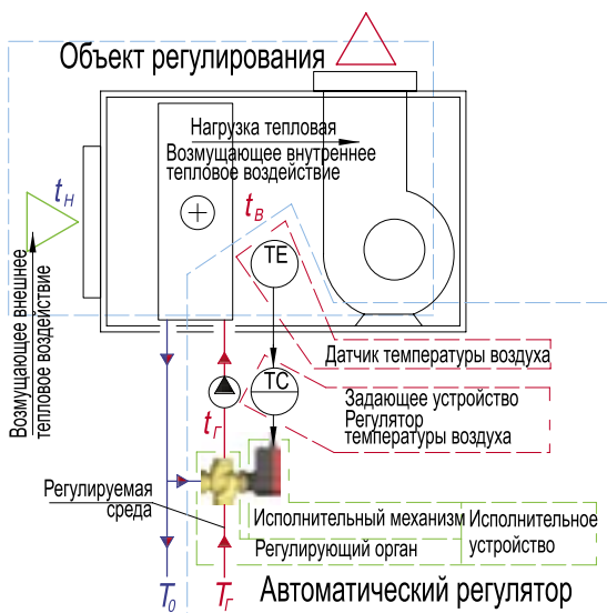
Рис. 1.6. Автоматическое регулирование температуры приточного воздуха вентилирующей системы
