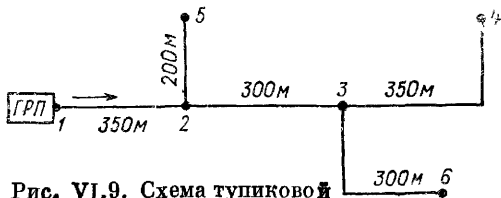
Рис. VI.9. Схема тупиковой газовой сети.
